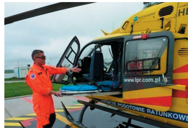
Fot. 3. Sławomir Lach – Kierownik łódzkiej filii SP ZOZ LPR (Region Wschodni), jeden z wielu pilotów Eurocoptera EC 135. Prezentowane nosze na platformie wysuwają się na zewnątrz do 2/3 długości (Port lotniczy Łódź-Lublinek)
