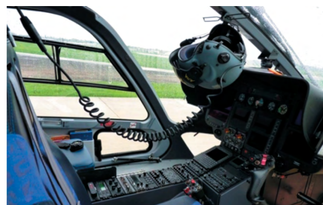
Fot. 5. Śmigłowiec Eurocopter EC 135, wnętrza kabiny pilota, obok którego miejsce zajmuje ratownik medyczny/pielęgniarka, który w trakcie lotu musi zająć się również nawigacją, obserwacją przestrzeni powietrznej oraz pomocą pilotowi (Port lotniczy Łódź-Lublinek)
