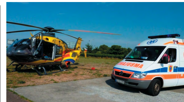
Fot. 6. Dojazd karetki po stronie lewej, wyłącznie wzdłuż śmigłowca, nie bliżej niż 2 metry od jakiegokolwiek elementu śmigłowca ze szczególnym zwróceniem uwagi na łopatę wirnika. Lądowisko śmigłowcowe – I CZMP (Łódź)
